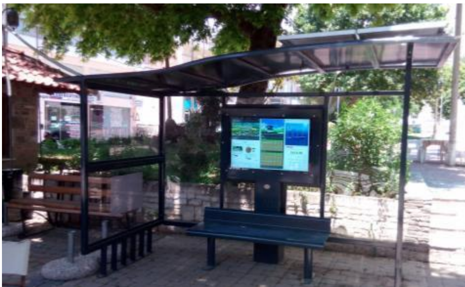
Εικόνα 5.9: Μεταλλικό υπόστεγοπληροφόρησης - «Ευφυής στάση» σύγχρονης αισθητικής, με επιφάνειες plexi-glass και σύστημα φωτοβολταϊκών (Πηγή: https://www.farkadona.gr/ )
