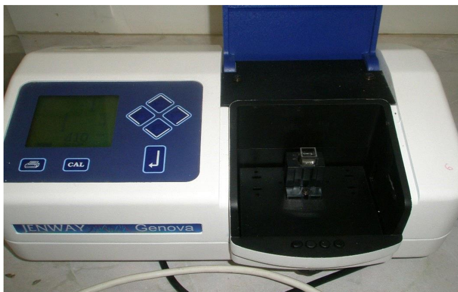
Εικόνα 7. Φασματοφωτόμετρο για την μέτρηση της απορρόφησης των δειγμάτων
