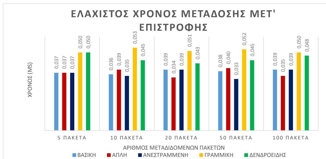
Διάγραμμα 3 : Ελάχιστος χρόνος μετάδοσης μετ' επιστροφής μεταξύ κόμβων για βασικές τοπολογίες OpenFlow
