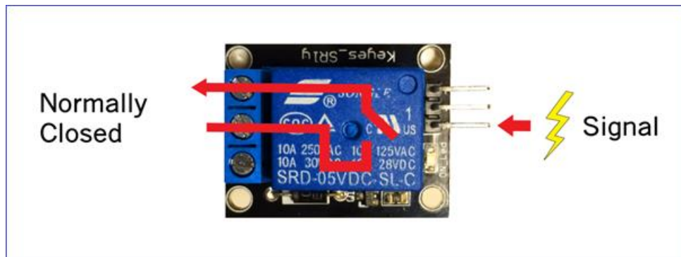
Εικόνα 12: Relay, επαφή NC. [xi]
