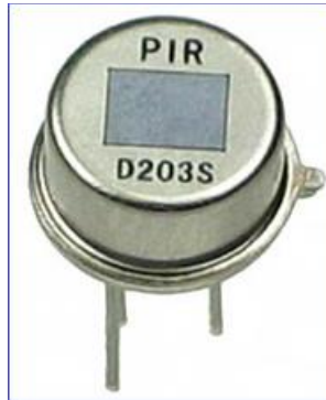
Εικόνα 7: Αισθητήρας κίνησης τύπου PIR [iv]
