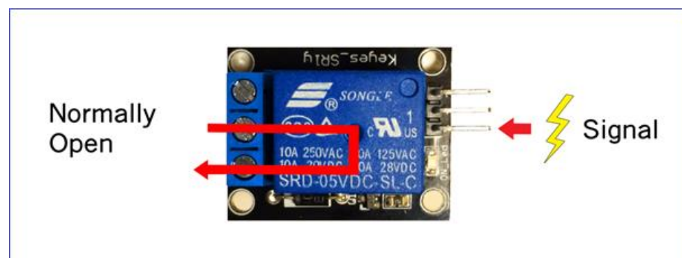
Εικόνα 11: Relay, επαφή NO. [xi]
