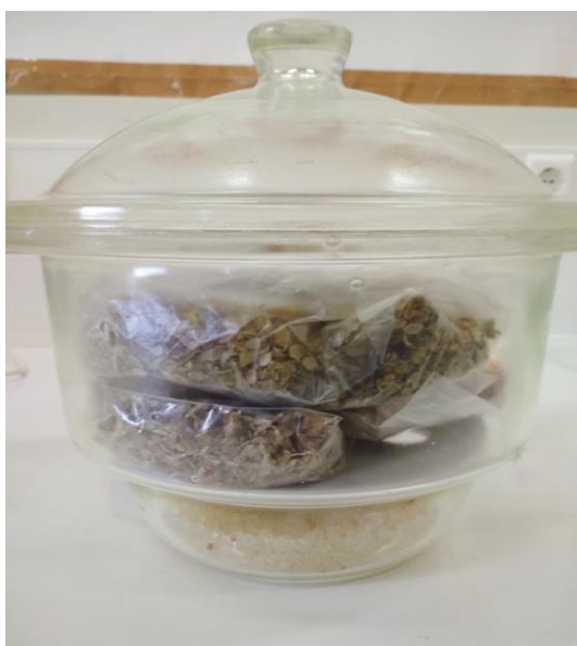
Εικόνα 17: Ξηραντήρας που χρησιμοποιήθηκε για τον περιορισμό της υγρασίας
