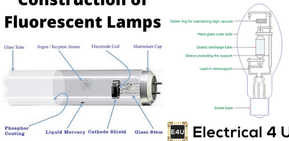
Εικόνα 25 Κατασκευή λαμπτήρα φθορισμού
