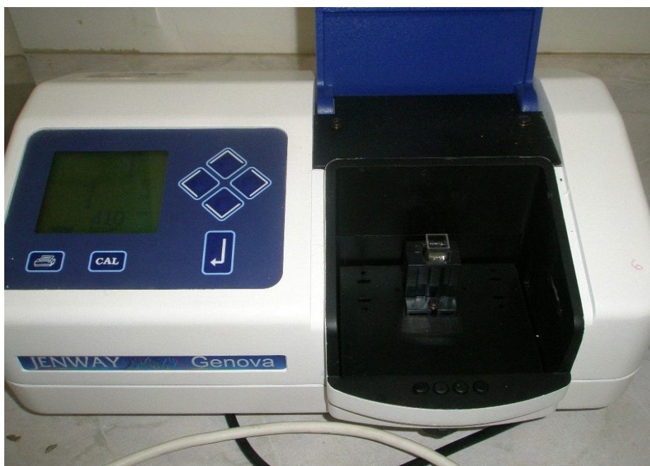
Εικόνα 1. Φασματοφωτόμετρο για την μέτρηση της απορρόφησης των δειγμάτων
