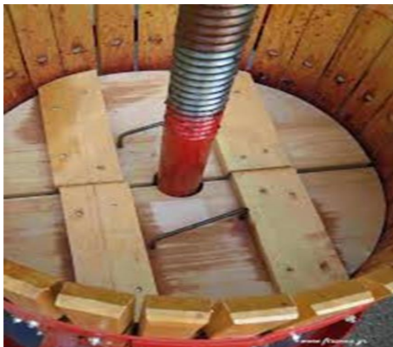
Εικόνα 4.1.2 Πιεστήριο με καλούπι όπου εισέρχεται στο τυρόπηγμα (ΠΕΡΙΦΕΡΕΙΑ ΗΠΕΙΡΟΥ, 2015).
