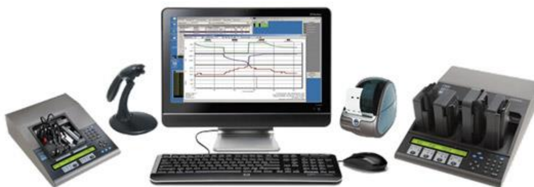
Εικόνα 6.13 Πλήρες σύστημα ανάλυσης μπαταριών.
