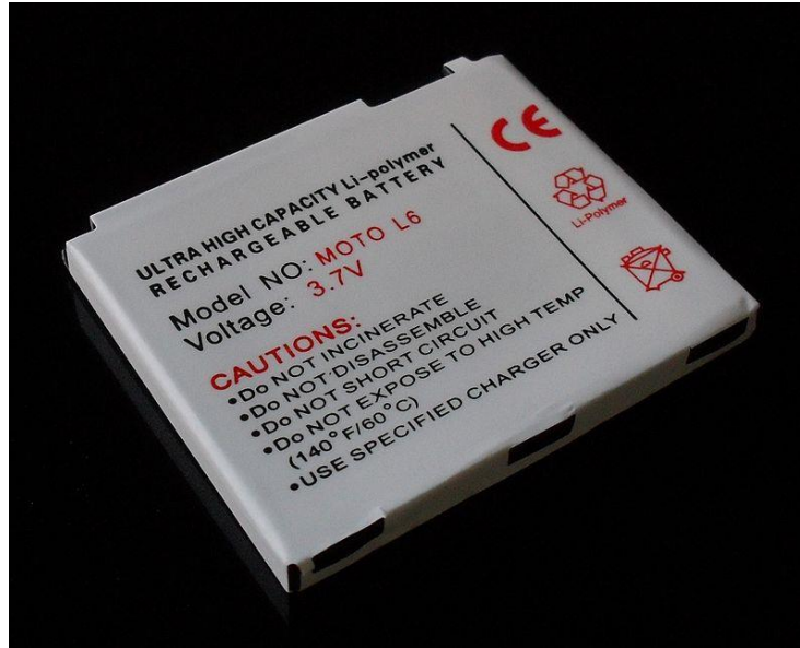
Εικόνα 5.15 Μια μπαταρία πολυμερούς λιθίου που χρησιμοποιείται για την τροφοδοσία ενός smartphone.
