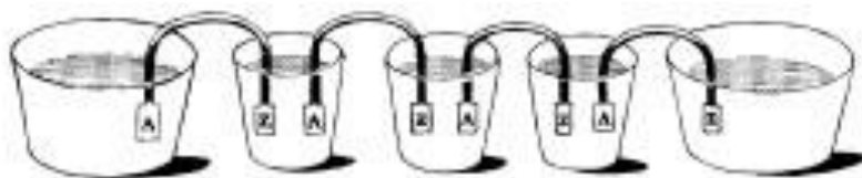
Εικόνα 5.2 Τα μέταλλα αργύρου (A) και ψευδάργυρου (Z) βυθίζονται σε κύπελλα γεμάτα ηλεκτρολύτη και συνδέονται σε σειρά.
