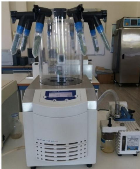
Εικόνα 4.2: Λυοφιλοποίηση των δειγμάτων φύλλων με το λυοφιλοποιητή Christ Alpha 1-2 LDplus.
