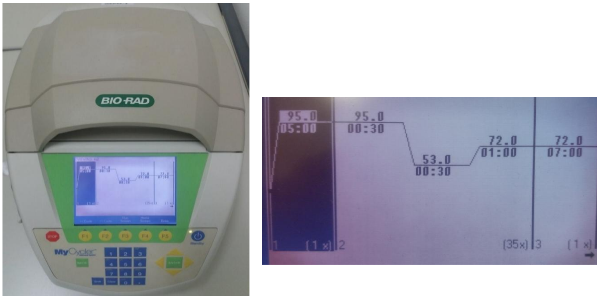
Εικόνα 4.17:Θερμικός κυκλοποιητής BioRad MyCycler Thermal Cycler και το πρόγραμμα που χρησιμοποιήθηκε.
