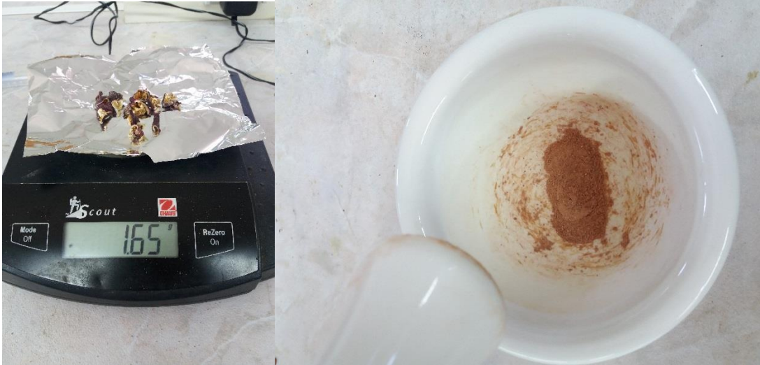
Εικόνα (5.15,5.16) : Μέτρηση ξηρού βάρους των δειγμάτων και κονιοροποίηση τους σε γουδί πορσελάνης.
