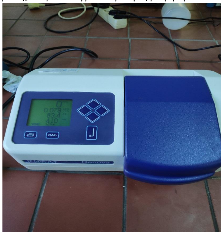
Εικόνα 5.29: Φασματοφωτόμετρο για την μέτρηση της απορρόφησης των δειγμάτων, σε μήκος κύματος 410 nm.
