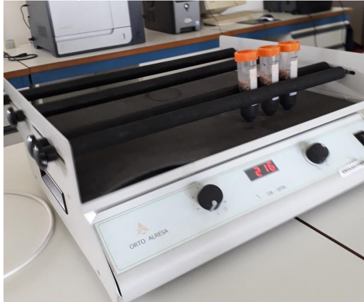
Εικόνα 5.6 Διαδικασία ανακίνησης σε οριζόντια πλάκα ανάδευσης
