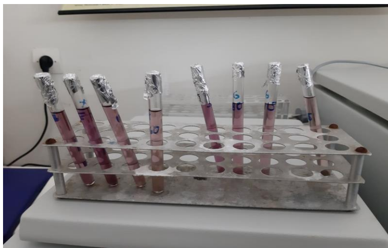
Εικόνα 18: Υάλινοι δοκιμαστικοί σωλήνες των 5 mL κατά την διαδικασία αντίδρασης των αντιοξειδωτικών ουσιών του αιθέριου ελαίου της δάφνης με το DPPH
