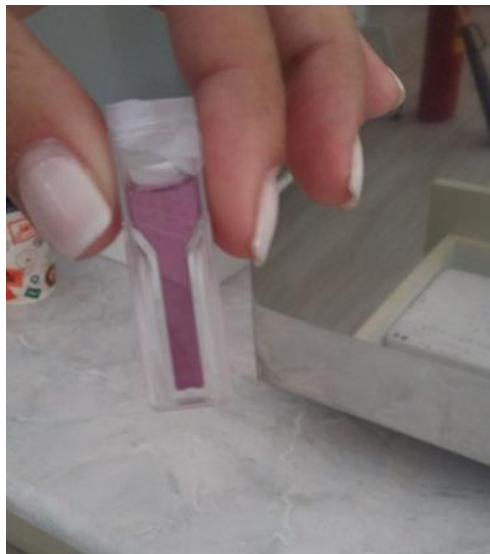
Εικόνα 13: Πλαστική κυβελίδα πριν την τοποθέτησή της στο φασματοφωτόμετρο UV
