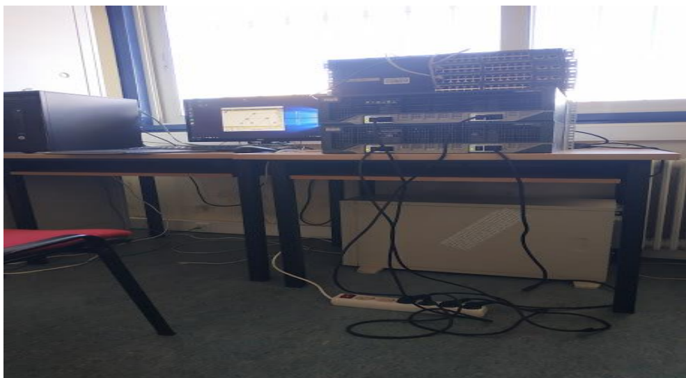
Εικόνα 34 Σενάριο με δύο router και δύο switch
