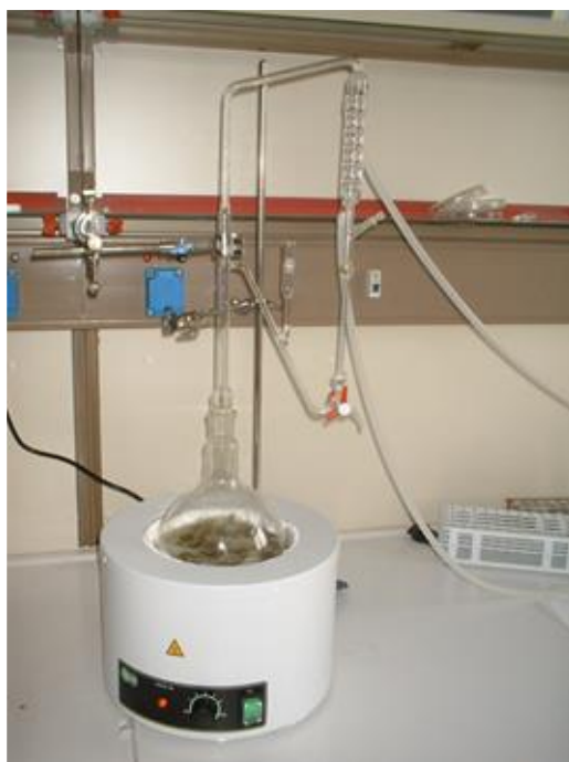
Εικόνα 4: Αποστακτική συσκευή με θερμομανδία του Εργαστηρίου Αρωματικών και Βιομηχανικών Φυτών (Τμήμα Φυτικής Παραγωγής, Τ.Ε.Ι. Ηπείρου) (Πηγή: Υφαντή - Ζήσης)
