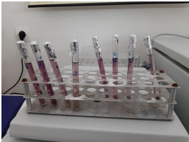
Εικόνα 6: Υάλινοι δοκιμαστικοί σωλήνες των 5 mL κατά την διαδικασία αντίδρασης ελαίου – DPPH.
