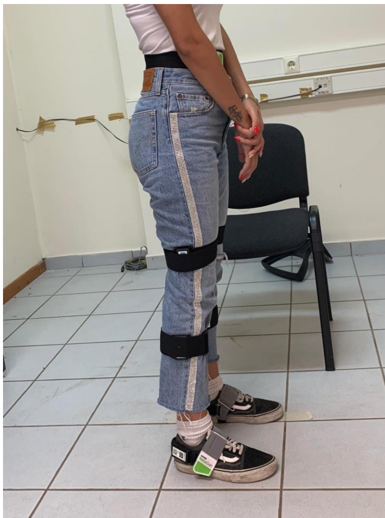
Εικόνα 5-6: Πλάγια Άποψη Τοποθέτησης Βιοαισθητήρων (Δεξιά)
