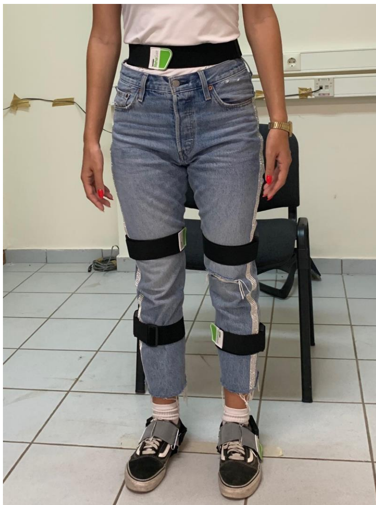
Εικόνα 5-4: Άποψη τοποθέτησης βιοαισθητήρων σε βαδιστή (πρόσθια άποψη)
