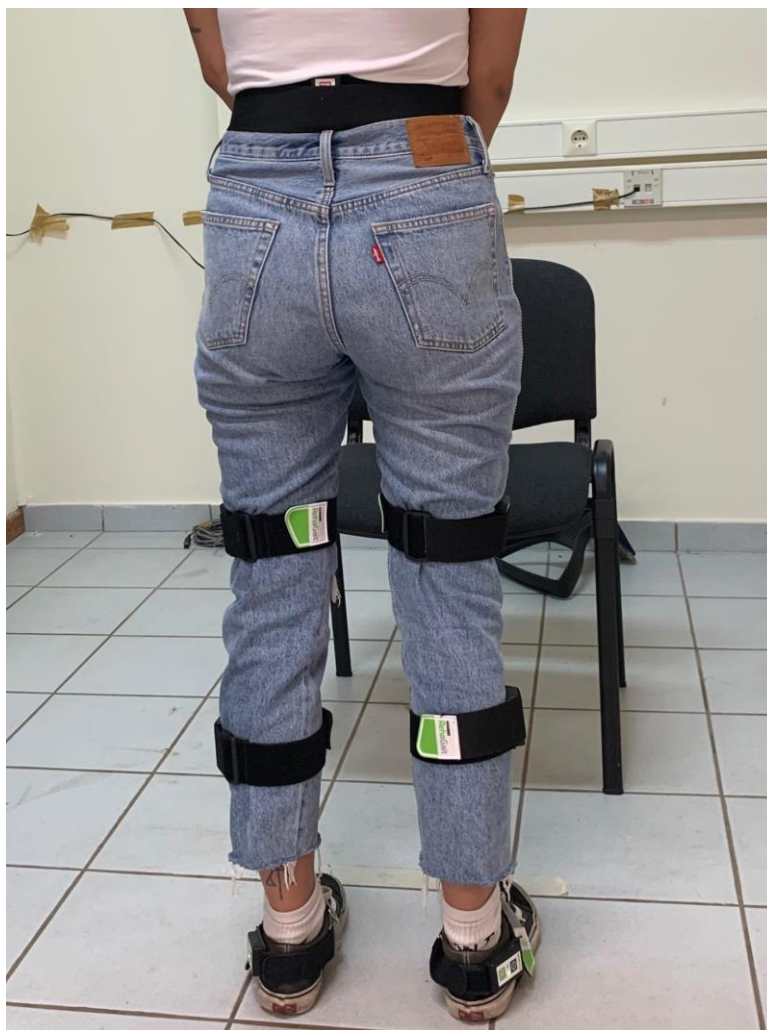
Εικόνα 5-5: Άποψη τοποθέτησης βιοαισθητήρων σε βαδιστή
