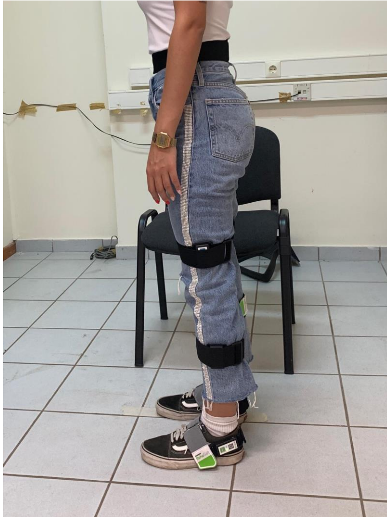
Εικόνα 5-7: Πλάγια άποψη τοποθέτησης βιοαισθητήρων ( Αριστερή)
