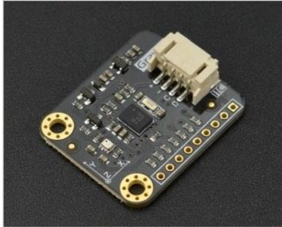
Εικόνα 28 gravity BNO055 + BMP280 10DOF AHRS (DFrobot, wiki.dfrobot.com)
