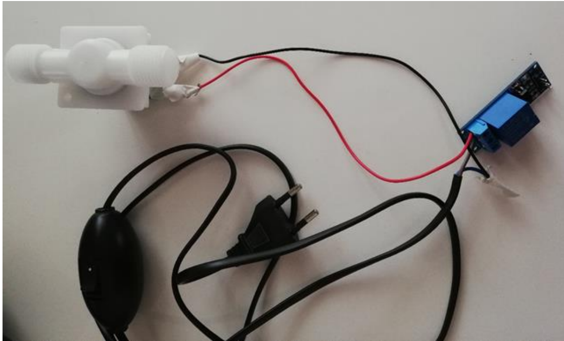
Εικόνα 4.13: Τρόπος σύνδεσης της ηλεκτροβάνας
