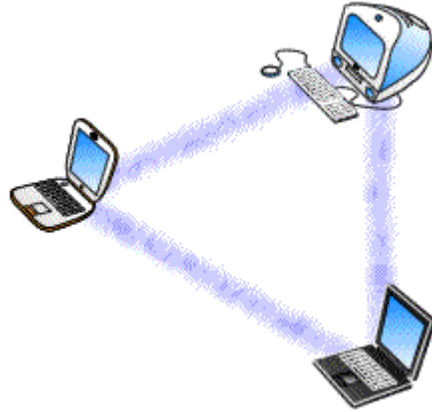
Σχήμα 1: Ad-hoc or peer to peer (H/Y με H/Y) Κάθε Η/Υ με ασύρματη επαφή μπορεί να επικοινωνεί απευθείας με όλους τους άλλους.
