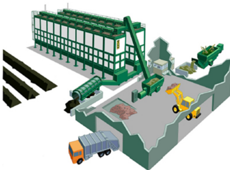
Σχήμα 3.4: Τεχνολογία VCU για την επεξεργασία οργανικών απορριμμάτων.
