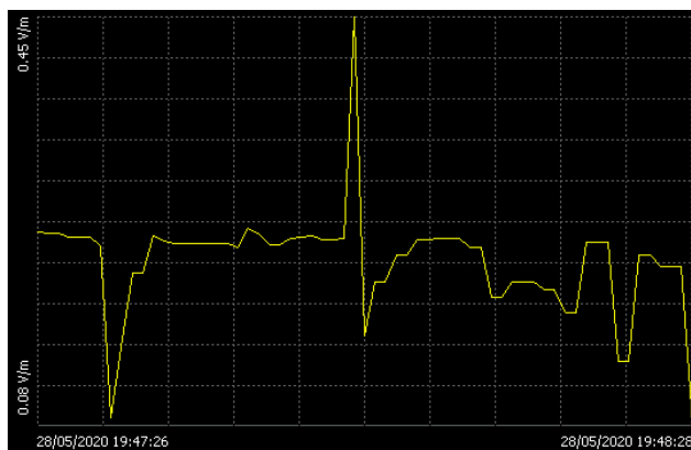
Μέτρηση 5: Αστάθεια με ομαλές μεταβολές του ηλεκτρικού πεδίου και μέγιστο στο 0,45 V/m.
