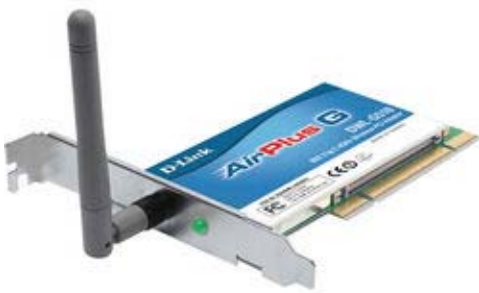
Εικόνα 1: D-LINK Κάρτα PCI WiFi 54 Mb DWL-G510 Data Link Protocol --> IEEE 802.11b
