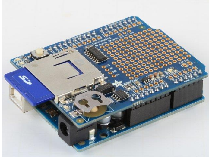
Εικόνα 4.2 Datalogger shield σε σύνδεση με Arduino UNO
