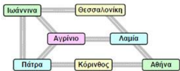
Εικόνα 16 : Ένα απλό οδικό δίκτυο απεικονίζεται με τη χρήση γράφων
