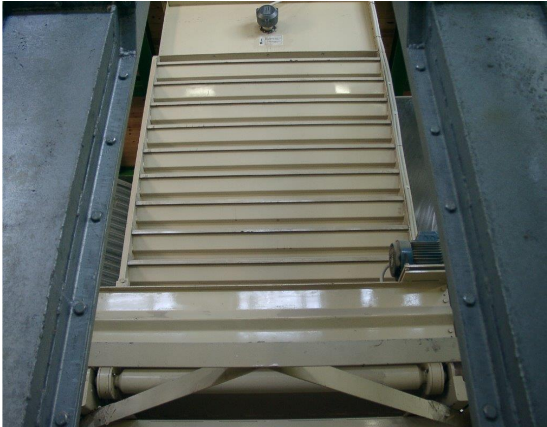
Εικόνα 28: Το ψυγείο όπου πραγματοποιείται η ψύξη και η αφύγρανση.
