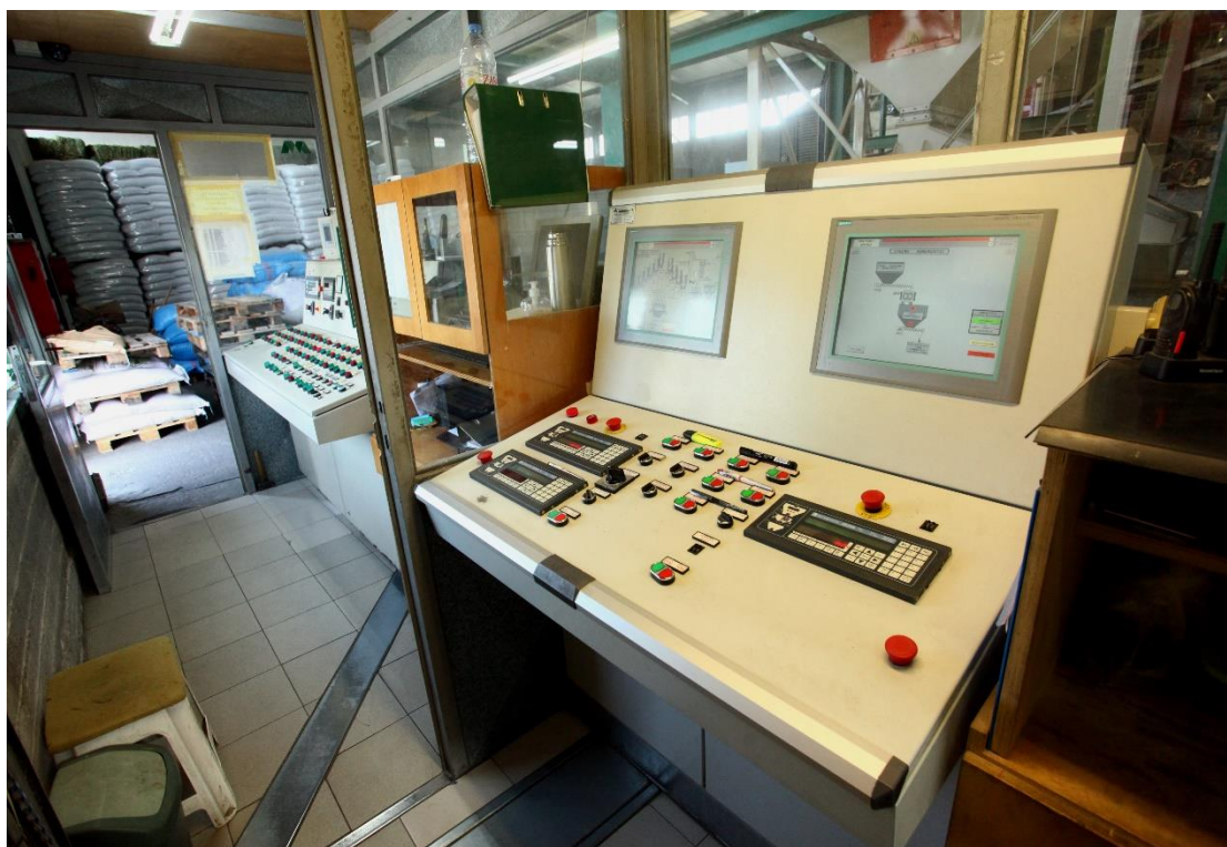
Εικόνα 24: Οι πίνακες ελεγχου του εργοστασιου, δεξια ο νεωτερος τεχνολογικα, και αριστερα ο παλαιοτερος.
