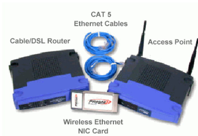
Εικόνα 10: Βασικός εξοπλισμός για ένα ασύρματο δίκτυο
