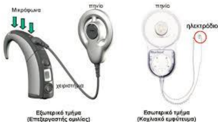
Εικόνα 8. Το σύστημα του κοχλιακού εμφυτεύματος
