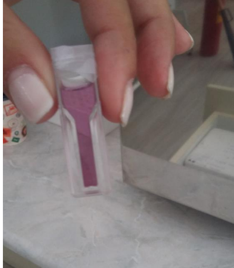
Κυψελίδα πριν την τοποθέτησή της στο φασματοφωτόμετρο UV.
