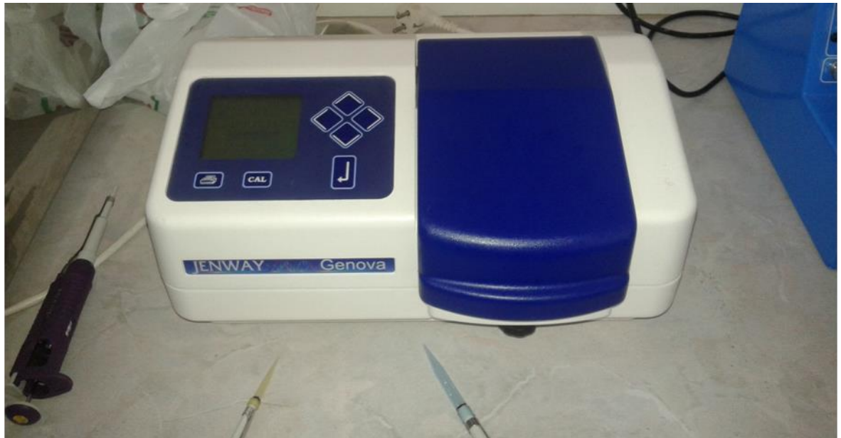
Εικόνα (4.10) : Φασματοφωτόμετρο για την μέτρηση της απορρόφησης των δειγμάτων, σε μήκος κύματος 410 nm.
