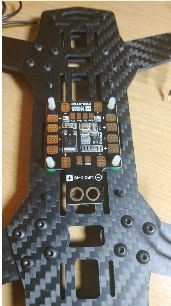
Εικόνα 27 Τοποθέτηση PDB XT60
