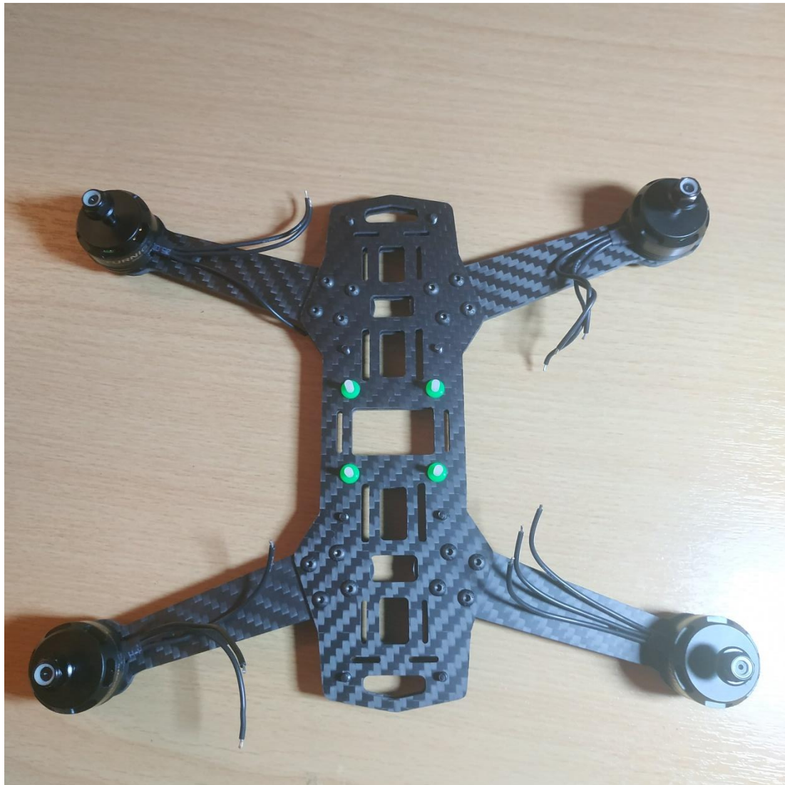
Εικόνα 25 Σκελετός μετά από την τοποθέτηση των Κινητήρων
