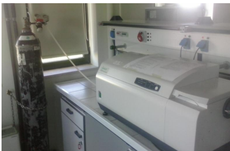
Εικόνα 5: Όργανο Κυκλικού Διχρωισμού συνδεδεμένο με αέριο άζωτο
