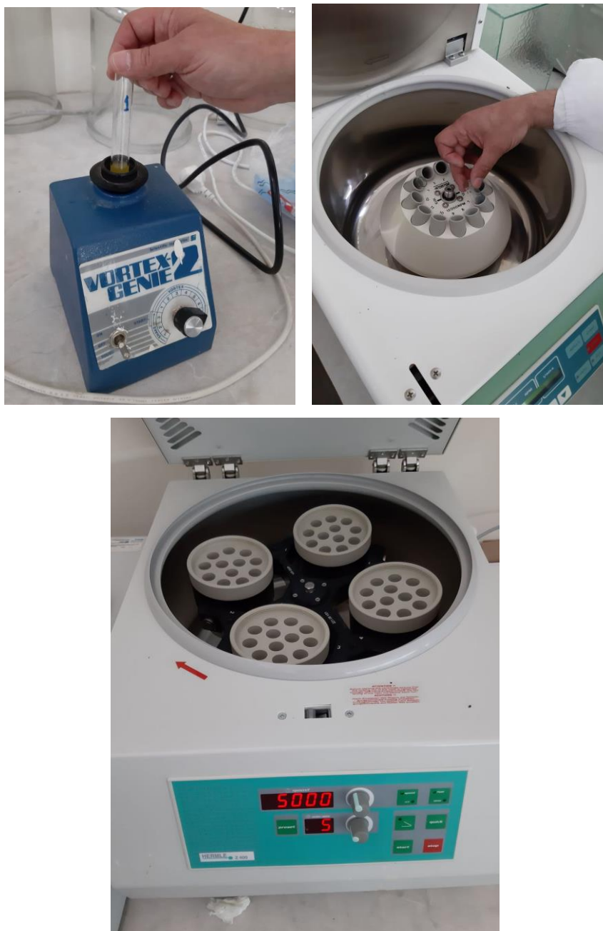
Εικόνες 4.5, 4.6, 4.7: Ανάμειξη διαλυμάτων ελαιόλαδου σε δοκιμαστικούς σωλήνες σε ειδικό μηχάνημα ανάδευσης (vortex) και φυγοκέντρωση για 5 min στις 5000 rpm
