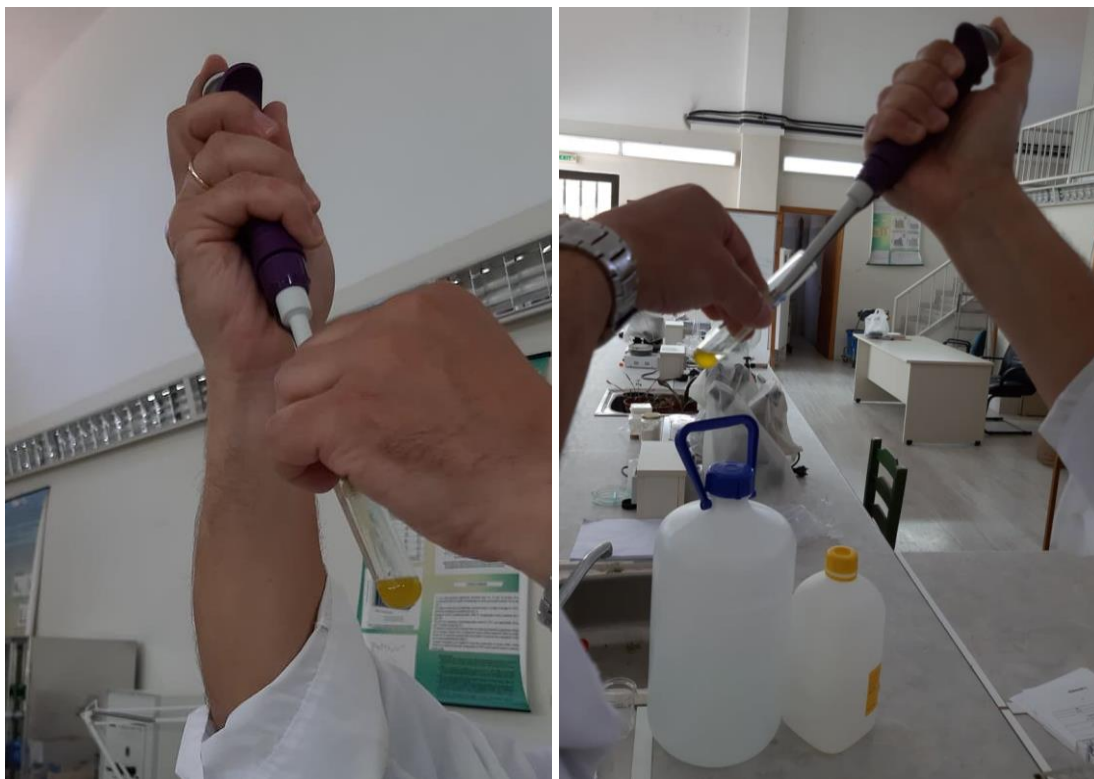
Εικόνες 4,8, 4.9: Προετοιμασία δειγμάτων σε μεθανολικό εκχύλισμα για τον προσδιορισμό της ολικής αντιοξειδωτικής ικανότητας του ελαιόλαδου με την μέθοδο DPPH
