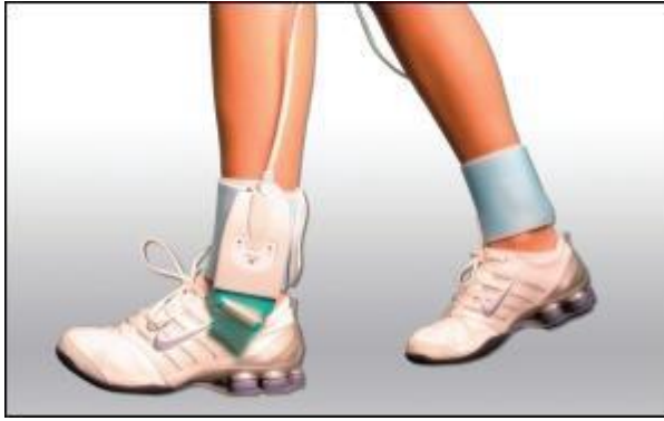
Εικόνα 16 : Αισθητήρας πίεσης ενσωματωμένος σε παπούτσι F-Scan (Abdul Hadi Abdul Razak , Aladin Zayegh , Rezaul K. Begg and Yufridin Wahab , Foot Plantar Pressure Measurement System: A Review, 23 July 2012)
