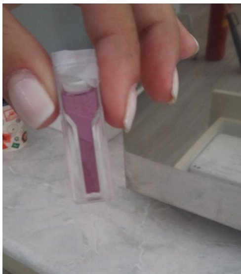
Εικόνα 15: Κυψελίδα πριν την τοποθέτησή της στο UV.
