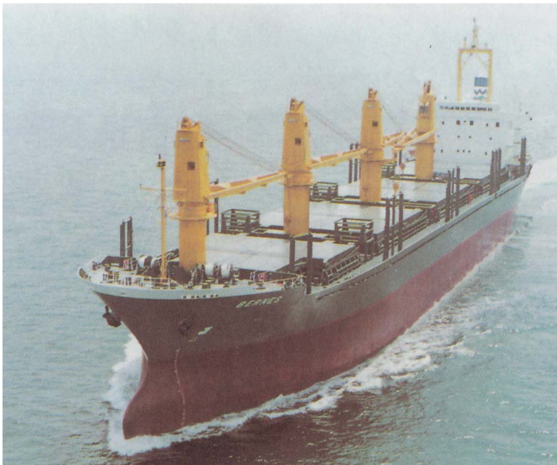
Self-unloading Bulk Carrier – Πλοίο Μεταφοράς Χύδην Ξηρών Φορτίων με εκφορτωτικά μέσα (γερανούς)
