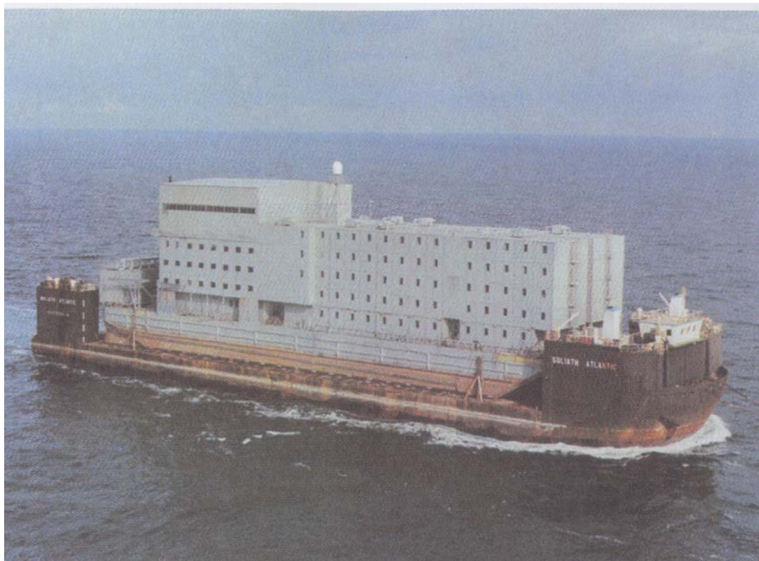
Floating Industry – Πλωτό Εργοστάσιο (Μεταφέρεται πάνω σε Φορηγίδα Υπερβαρέων Φορτίων)
