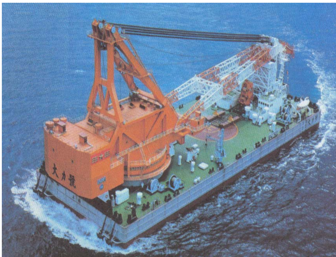
Floating Crane – Πλωτός Γερανός μεγάλης Ανυψωτικής Ικανότητας (2.500 Τόνων)
