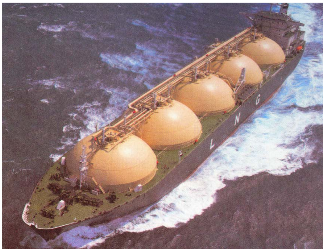
L.N.G. Carrier – Πλοίο Μεταφοράς Υγροποιημένου Φυσικού Αερίου (οι μπάλλες Φορτίου Εξωτερικά)
