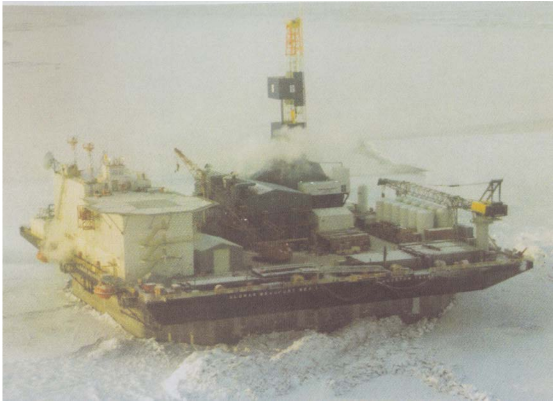
Concrete Island Drilling System – Πλωτό Νησί – Σταθμός Εξόρυξης Πετρελαίου και Αερίων (Κινούμενο, ειδικά κατασκευασμένο για την Αρκτική Θάλασσα)
