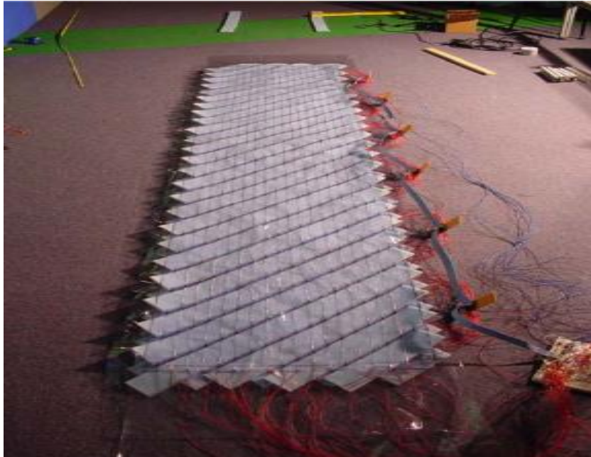
Εικόνα 3.6 Διάδρομος καταγραφής βάδισης με αισθητήρες.
