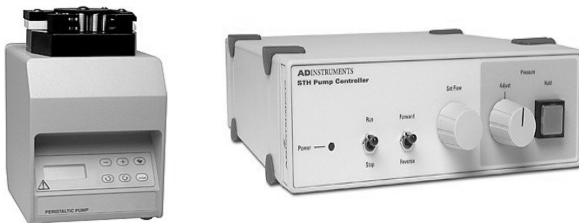
Εικόνα 9: Η περιστροφική αντλία (αριστερά) και η κονσόλα ελέγχου της (δεξιά).
