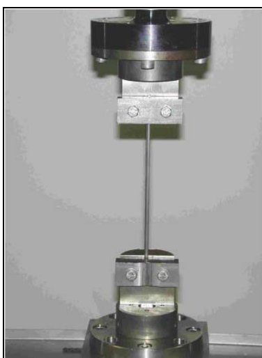
Εικ. 1: Η τοποθέτηση του ήλου στο ειδικό μηχάνημα
