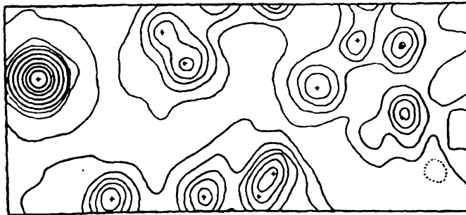
Σχήμα 3.19 Καμπύλη ισοκατανομής ηλεκτρικού φορτίου στο χώρο (διδιάστατη ηλεκτρονική πυκνότητα), όπως εξάγεται από μετρήσεις ελαστικά σκεδαζόμενης ακτινοβολίας.
