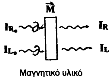
Σχήμα 4.30 Ξεχωριστή μέτρηση της δεξιόστροφα και αριστερόστροφα κυκλικά πολωμένης ακτινοβολίας.
