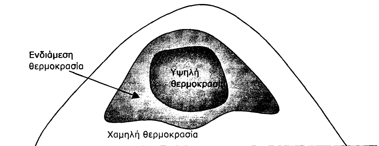
Σχήμα 8.5 Τυπικό προφίλ θερμοκρασιακής κατανομής μέσα σε ένα σειράδι
