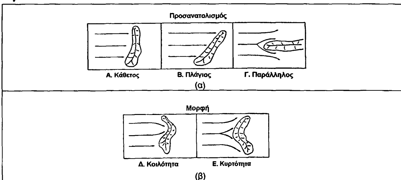
Σχήμα 1.8.10: Η επίδραση (α) του προσανατολισμού και (β) της μορφής των κορυφών μιας οροσειράς στην κατάσταση του ανέμου.
