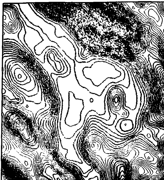
Σχήμα 3.4.14: Εισαγωγή χάρτη στο «WAsP». Με γκρι γραμμές στο χάρτη του λεκανοπεδίου Ιωννίνων και της περιοχής Κατσικά, σημειώνονται οι ισούψεις καμπύλες για τις οποίες είναι δυνατόν να προσδιοριστούν τιμές μήκους τραχύτητας.
