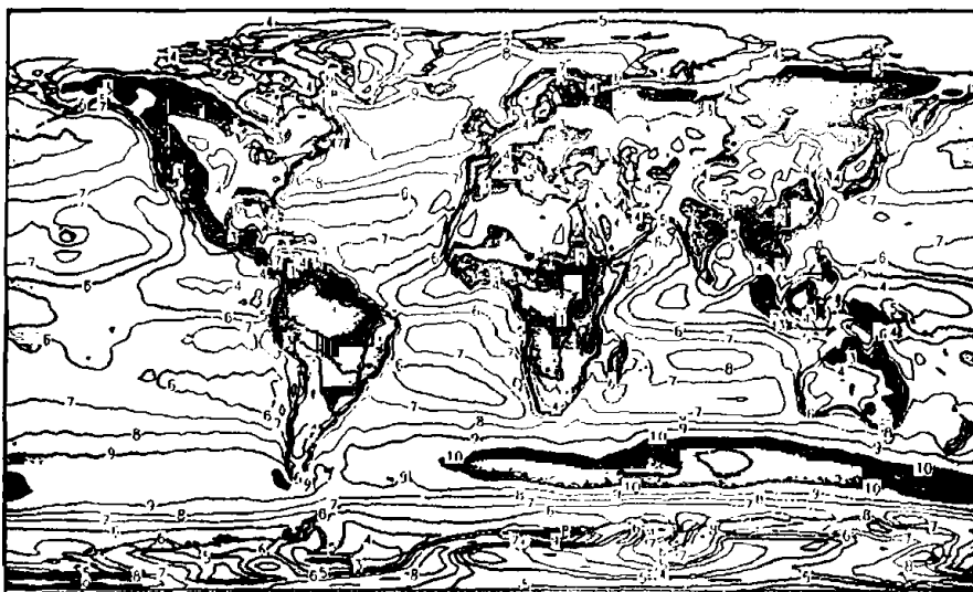
Σχήμα 1.6.1: Παγκόσμια κατανομή της μέσης ταχύτητας του ανέμου (σε m/s) στα 10 m από το έδαφος, για τη χρονική περίοδο 1976–1995 [Πηγή: NCEP/NCAR].
