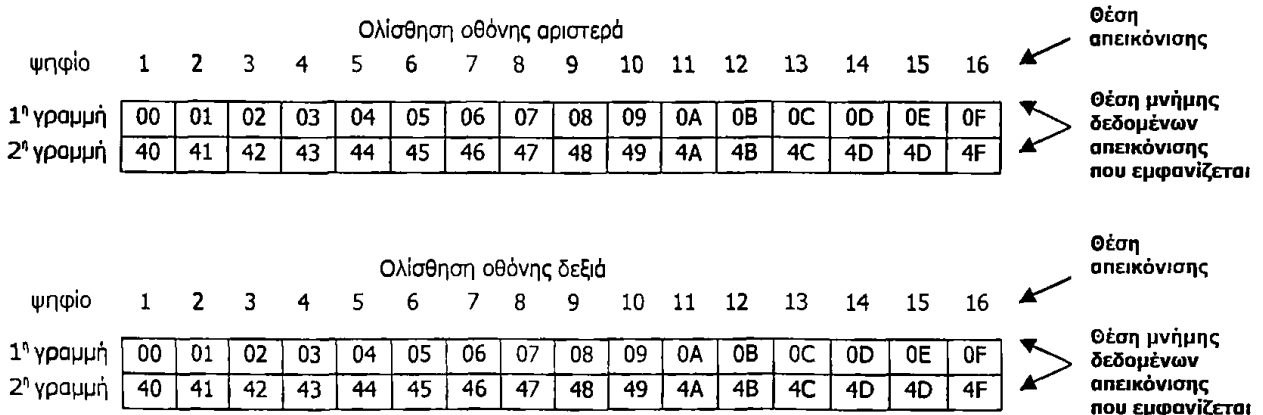
Σχήμα Γ1.3: Περιοχή απεικόνισης μετά από ολίσθηση
