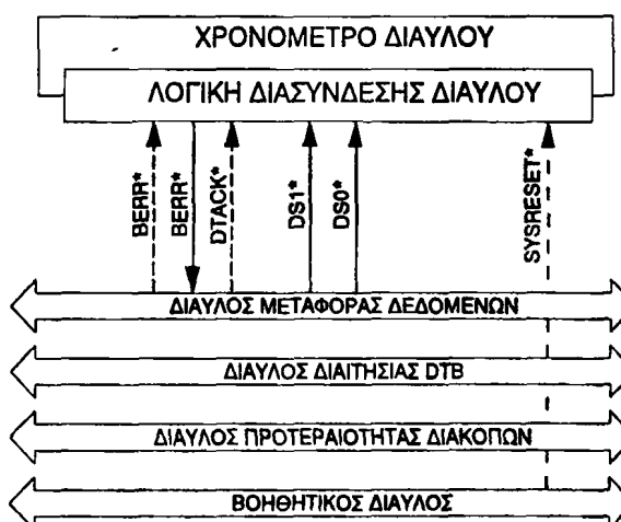
σχ. 82. Διάγραμμα βαθμίδας χρονομέτρου διαύλου
