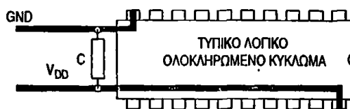
σχ. 114. Τοποθέτηση πυκνωτή αποσύζευξης
