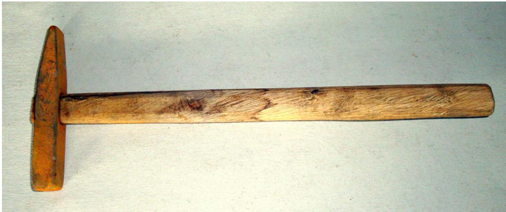
Εικ. 60: Μικρό σφυρί , που το χρησιμοποιεί ο μάστορας στην κατασκευή της μπρούντζινης λαβής. Διαστάσεις μεταλλικού μέρους 9,5εκ.X1εκ.X1,5εκ. και μήκος στείλιariού 25 εκ.
