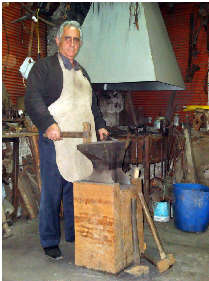
Εικ. 48: Ο μάστορας Παναγιώτης Ρηγάλος στο εργαστήρι του. Κρατάει το σφυρί και χτυπάει στο μεγάλο αμόνι βάρους 120 κιλών. Μπροστά στο ξύλινο στήριγμα του αμονιού είναι όρθια στημένες η βαριά και η βαριοπούλα, ενώ δεξιά διακρίνεται το καμίνι με τις τσιμπίδες και την καμινάδα.
