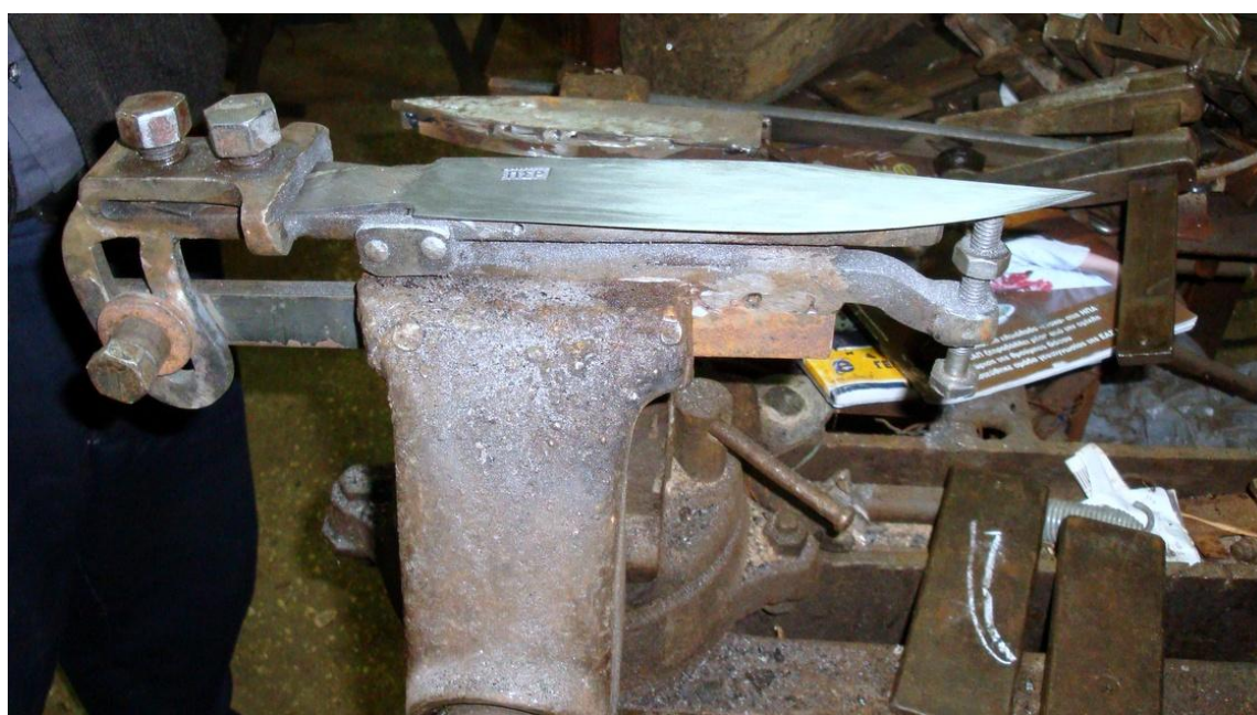
Εικ. 85, 86: Ειδικό εργαλείο για το λιμάρισμα των μαχαιριών. Αποτελεί ευρεσιτεχνία του μάστορα και το κατασκεύασε μόνος του. Διαστάσεις: 33εκ.X 6εκ.X13εκ.
