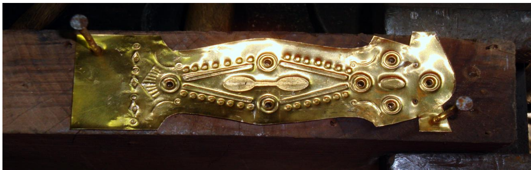
Εικ. 105: Φουσκωτά σχέδια, τα οποία γίνονται με χτυπήματα στην εσωτερική πλευρά του μπρούντζου.
