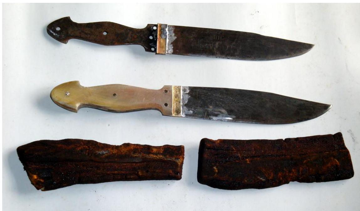
Εικ. 190: Επισκευή παλιών μαχαιριών. Στο ένα θα τοποθετηθούν κεράτινα μανίκια στη λαβή. Διακρίνονται τα κομμάτια από κέρατα κριαριού που θα χρησιμοποιηθούν και τα οποία έχουν ζεσταθεί στη φωτιά και ισιώσει στη μέγγενη. Στο άλλο έχουν ήδη τοποθετηθεί κεράτινα μανίκια. Εκκρεμεί το πέρασμα με σφυριδόχαρτο και το γυάλισμα με λάδι.
