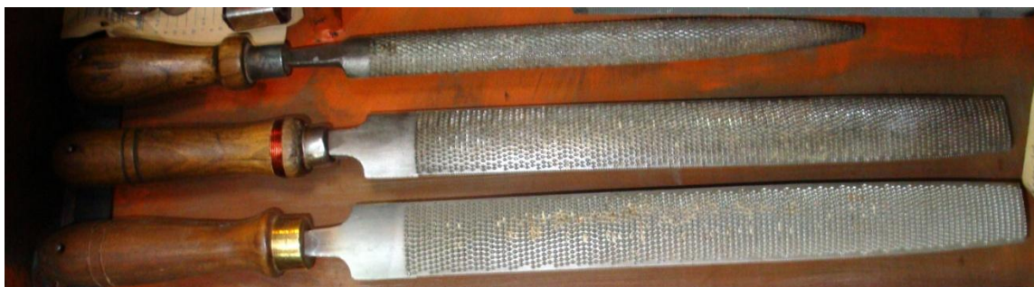
Εικ. 76: Ράσπες, ειδικές λίμες για τις ξύλινες θήκες και τα κεράτινα μανίκια.
