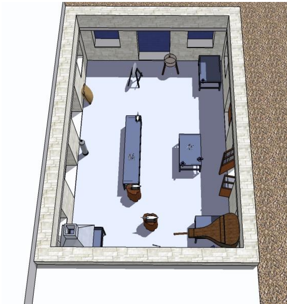
Εικ. 49: Τρισδιάστατο σχέδιο του εσωτερικού χώρου του εργαστηρίου, όπου διακρίνεται η διάταξη του εξοπλισμού: οι πάγκοι εργασίας, τα τρία αμόνια, το σταθερό και το μικρό καμίνι, το φουσερό και ο ποδοκίνητος τροχός. (Σχέδιο του αρχιτέκτονα Ηλία Χαρίτου βασισμένο σε προσχέδιο του Μάνθου Σταμούλη και στο φωτογραφικό υλικό της έρευνας)
