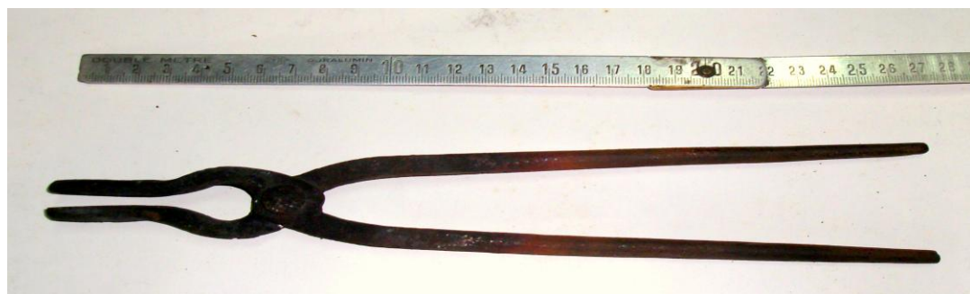
Εικ. 63: Μικρή τσιμπίδα. Τη χρησιμοποιεί περισσότερο κατά τη διαδικασία της βαφής της λάμας του
