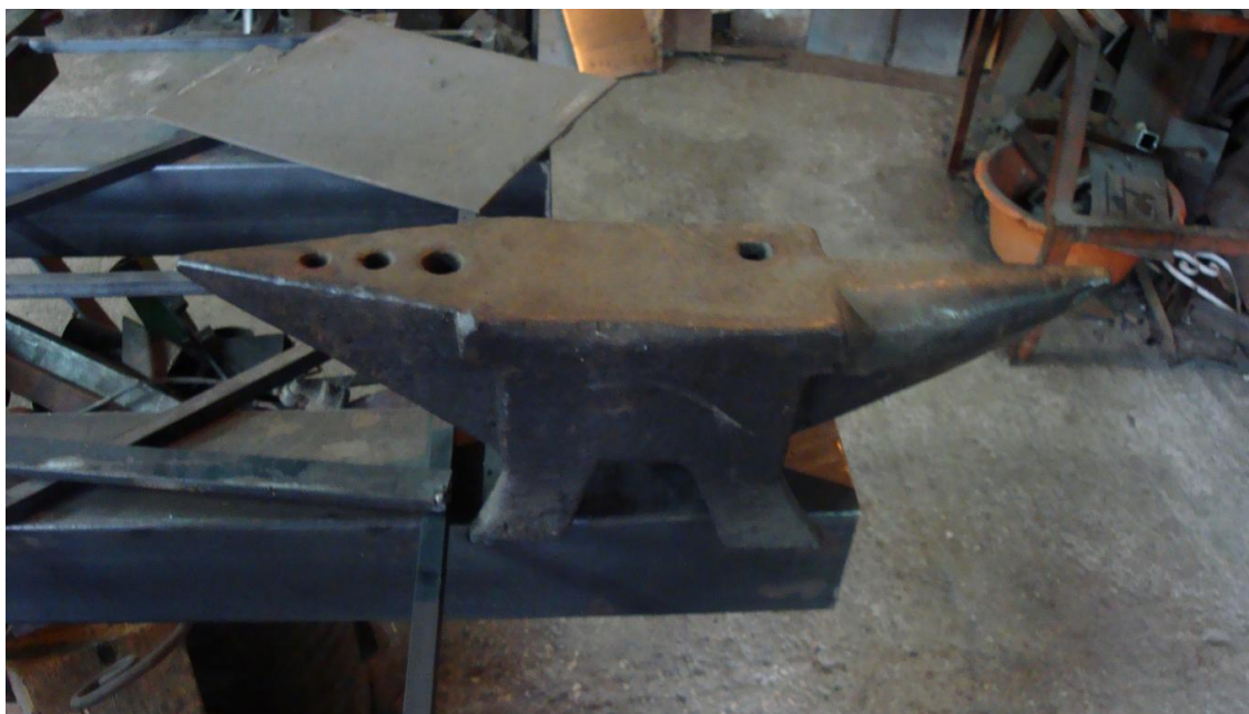
Εικ. 54: Το πρώτο και για πολλά χρόνια μοναδικό αμόνι του μάστορα. Ζυγίζει 25 κιλά.
