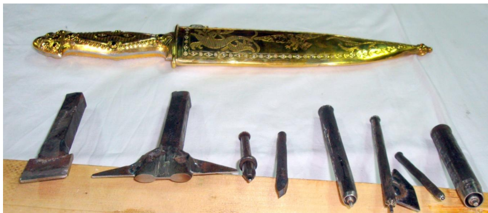
Εικ. 82: Μικρό καυομάχαιρο και εργαλεία διακόσμησης των μανικιών και της θήκης, εργαλεία τα οποία κατασκεύασε μόνος του ο Παναγιώτης Ρηγάλος
