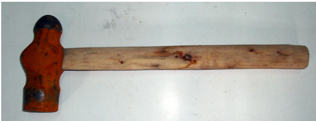
Εικ. 61: Σφυρί για το πριτσινάρισμα . Διαστάσεις μεταλλικού μέρους 12,5εκ.X5εκ.X3,5εκ. Μήκος στείλιariού 32εκ.
