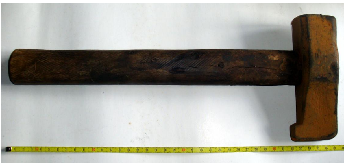
Εικ. 59: Σφυρί ειδικό για τη σφυρηλάτηση των μαχαιριών. Το λεπτότερο σε πάχος και φαρδύτερο μέρος του διευκολύνει τη σφυρηλάτηση σε δύσκολα σημεία. Είναι φτιαγμένο από τον ίδιο το μάστορα.
