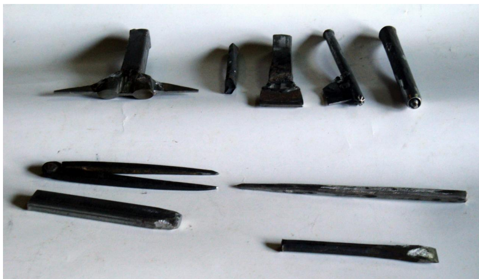
Εικ. 83: Ατσάλινα εργαλεία διακόσμησης κατασκευασμένα από τον ίδιο τον Παναγιώτη Ρηγάλο
