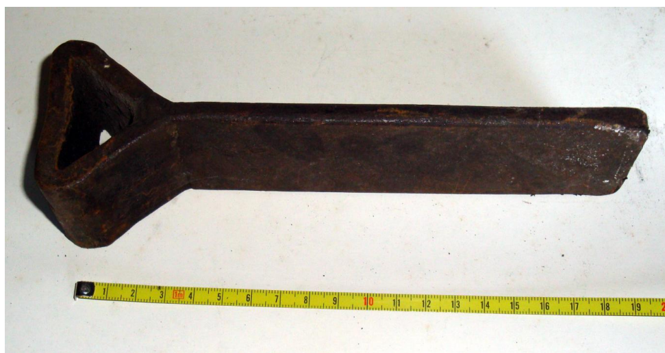
Εικ. 84: Ατσάλινο εργαλείο-καλούπι για το γύρισμα των κεράτων. Το κατασκεύασε ο ίδιος ο μάστορας
