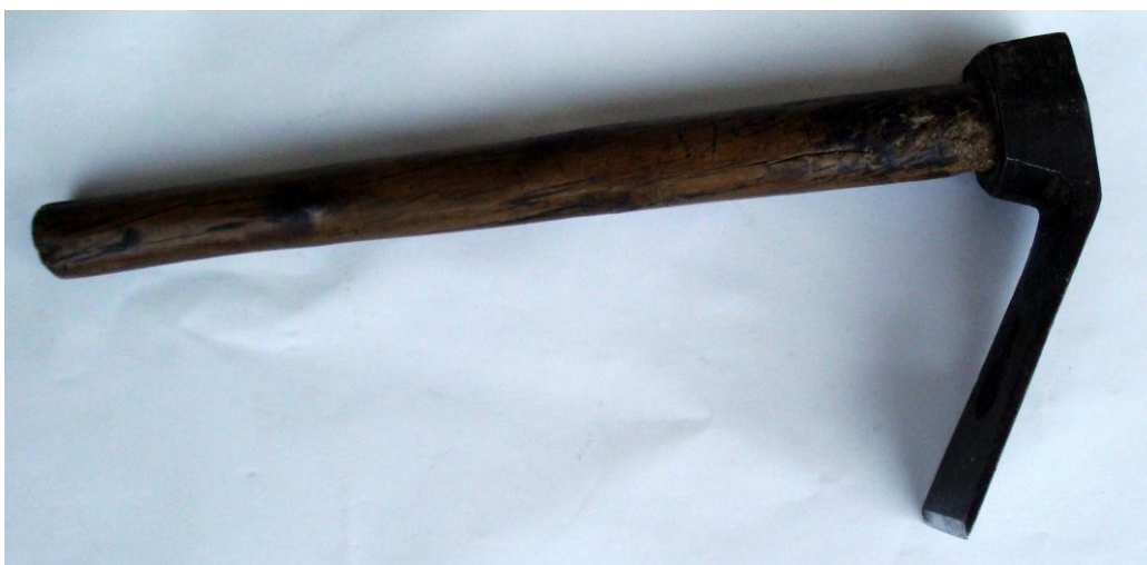
Εικ. 71: Σκεπάρνι ξυλουργού. Διαστάσεις μεταλλικού μέρους 15εκ.Χ5,5εκ. Μήκος στελλιαριού από ξύλο αγριελιάς 31 εκ.
