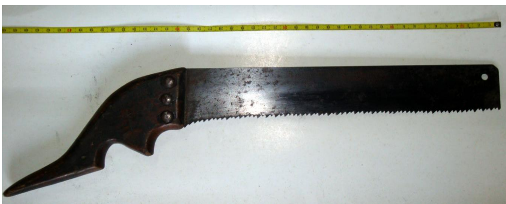
Εικ. 70: Πριόνι ξυλουργού συνολικού μήκους 45 εκ. Μήκος λάμας 29 εκ. και πλάτος λάμας 5 εκ. Με αυτό κόβει ξύλα και κέρατα.
