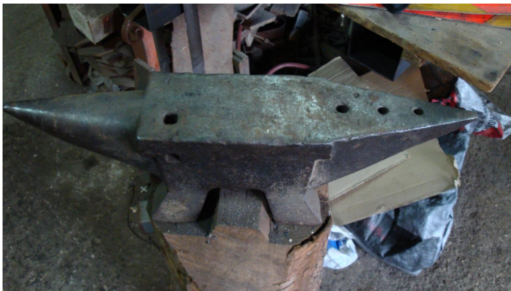
Εικ. 55: Το μεσαίο αμόνι του εργαστηρίου, το οποίο ζυγίζει 55 κιλά.
