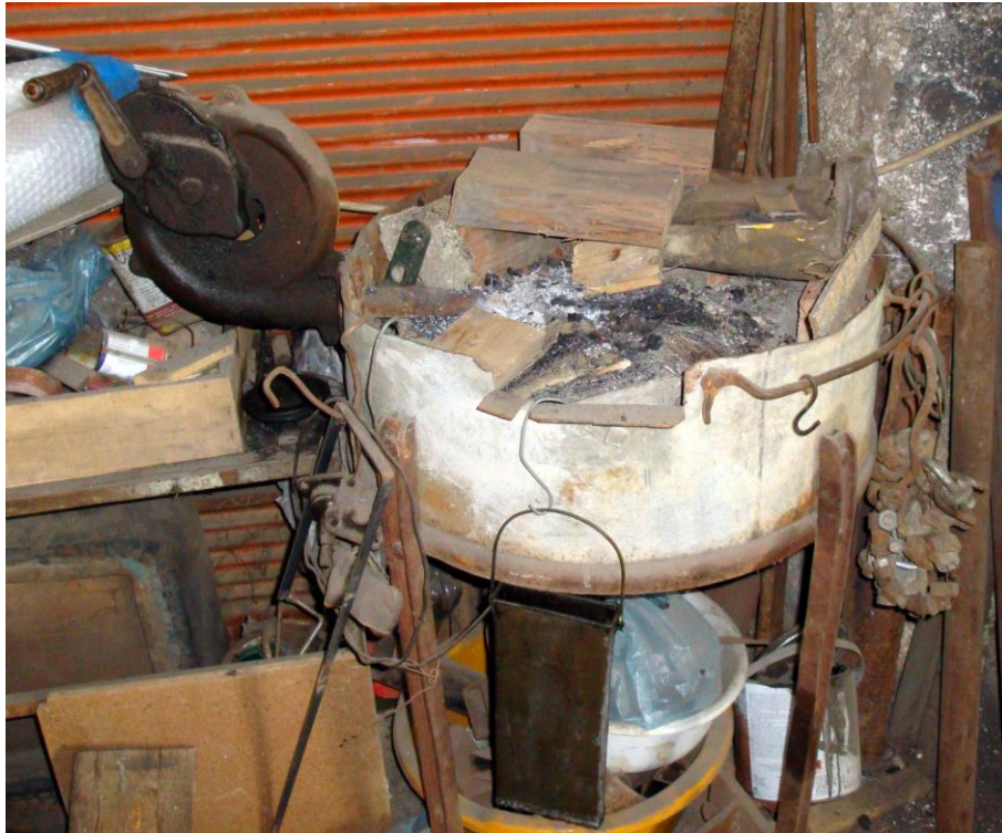
Εικ. 53: Το μικρό καμίνι . Έχει διάμετρο 0.6μ. και ύψος 0.8μ. Διακρίνεται αριστερά ο σαλίγκαρος-χειροκίνητο φουσερό και στο μπροστινό μέρος είναι κρεμασμένη σε συρμάτινο γάντζο η βούτα με το ελαιόλαδο.
