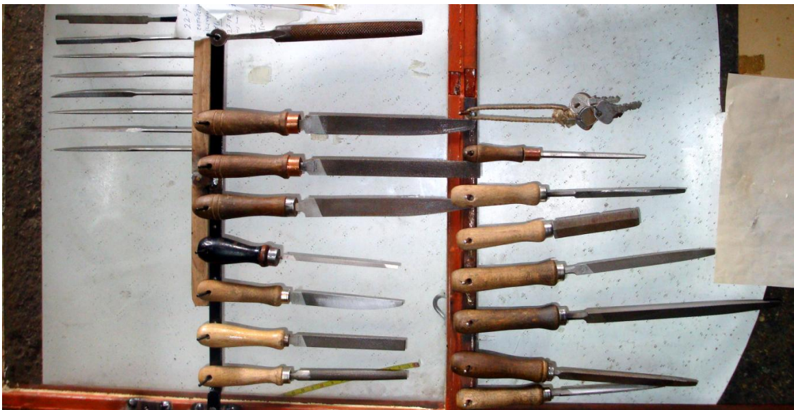
Εικ. 74: Λίμες για τη μεταλλική λάμα. Είναι καμωμένες από ατσάλι, έχουν πολύ μικρά και λεπτά δοντάκια, και μ' αυτές ρινίζει τις λάμες του μαχαιριού και τις λεπταίνει ξεκόβοντας τρίμματα.
