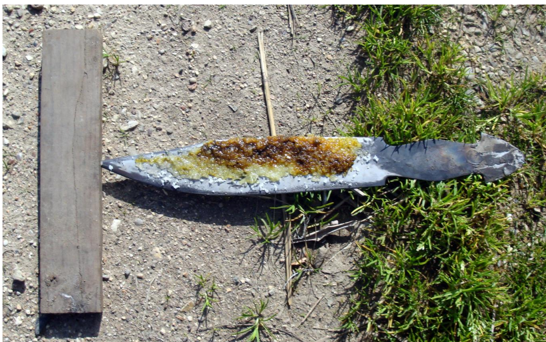
Εικ. 100: Το νιτρικό οξύ με τη βοήθεια του αλατιού επιδρά πάνω στα σημεία της λάμας από τα οποία έχει αφαιρεθεί το κερί, διαβρώνει το μέταλλο και αποτυπώνει τα σχέδια και τα γράμματα στη λάμα του μαχαιριού.
