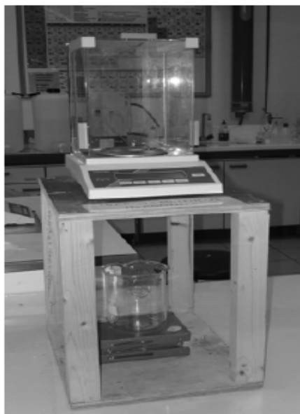
Εικόνα 3.13. Πειραματική διάταξη για μετρήσεις πυκνότητας.
