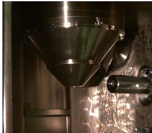
Εικόνα 5. Ηλεκτρονικό μικροσκόπιο σάρωσης και αντικειμενικός φακός εστίασης.
