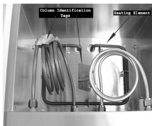
Σχήμα 5.4: Χαρακτηριστική διάταξη θερμοστατούμενης στήλης εντός «φούρνου» ενός αέριου χρωματογράφου
