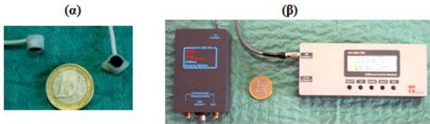
Σχήμα 2.18. (α) Υπερηχητικοί μετατροπείς από βιοσυμβατά υλικά και κατάλληλο σχεδιασμό για εμφύτευση και β) συσκευή καταγραφής των σημάτων και ασύρματης αποστολής τους αποτελούμενη από δυο λειτουργικές μονάδες [6, 32].
