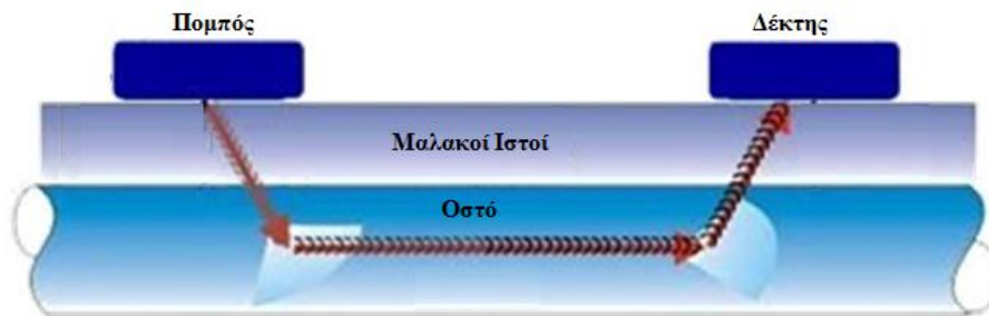
Σχήμα 2.1. Η γεωμετρία της τεχνικής αξονικής διάδοσης σε μακρά οστά στην οποία ο πομπός και ο δέκτης τοποθετούνται διαδερμικά.
