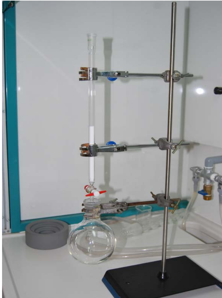
Εικόνα 9.2: Η χρωματογραφική στήλη εσωτερ. διαμέτρου 10 mm για τη διαδικασία καθαρισμού.
