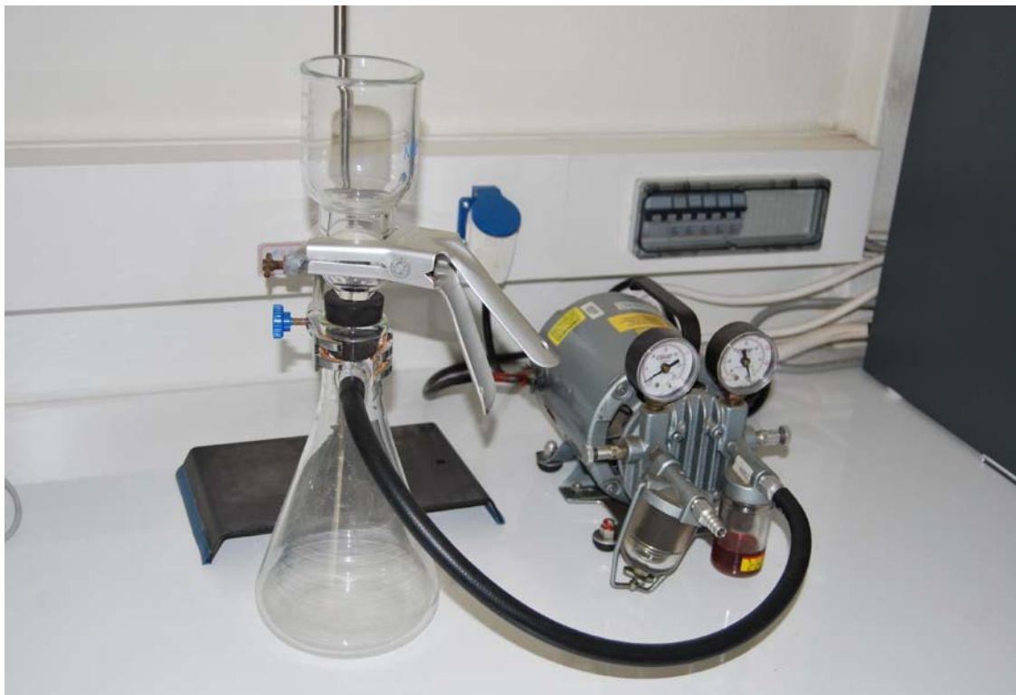
Εικόνα 10.1: Η συσκευή εκχύλισης με την τεχνική SPE, υδατικών δειγμάτων με δίσκους \text{C}_{18} των 47 mm.
