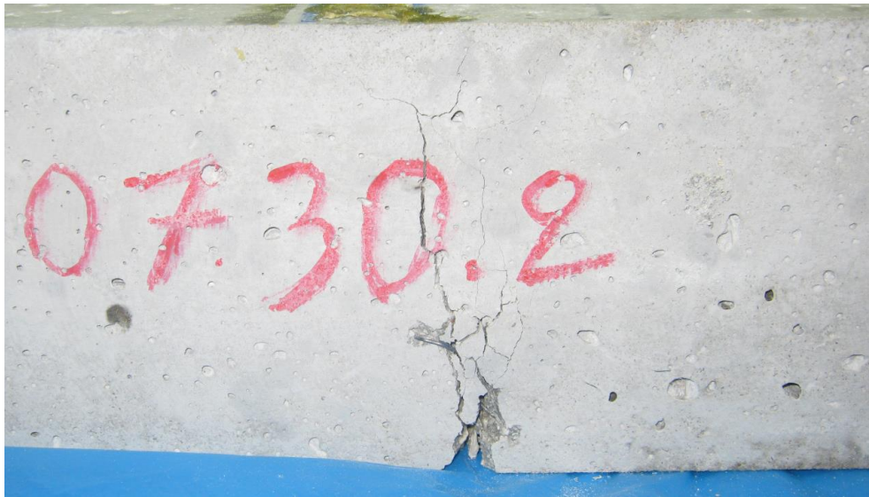
Εικόνα 4.2.14. Δοκίμια μετά τη δοκιμή κάμψης με α) ευθείες, β) κεκαμένα άκρα, γ) κυματοειδείς ίνες
