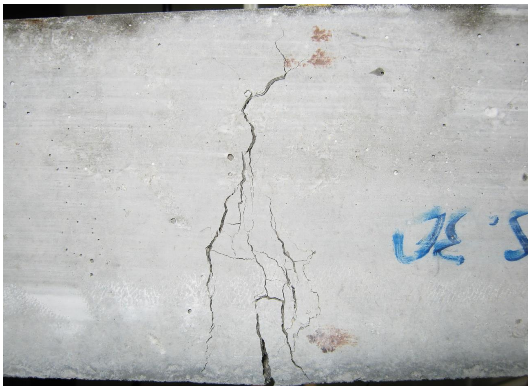
Εικόνα 4.4.10. Δοκίμια μετά από τη δοκιμή κάμψης με α) ευθείες, β) κεκαμμένα άκρα, γ) κυματοειδείς τροποποιημένες ίνες
