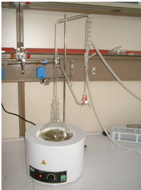
Εικόνα 26: Αποστακτική συσκευή με θερμομανδύα του Εργαστηρίου Αρωματικών και Βιομηχανικών Φυτών (Τμήμα Τεχνολόγων Γεωπόνων, Τ.Ε.Ι. Ηπείρου)
